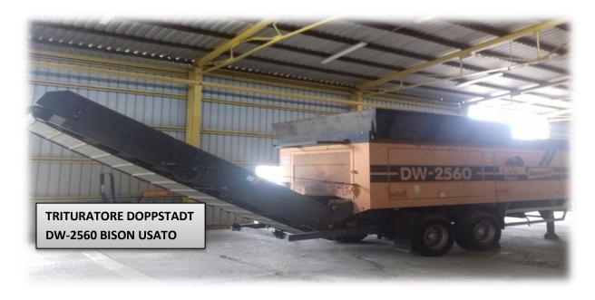
**DESCRIZIONE DELLE ATTREZZATURE:** trituratore DOPPSTADT DW-2560 BISON usato fornito di radiocomando, nastro di scarico, impianto di avanzamento, griglia di frantumazione, anno 1998.
